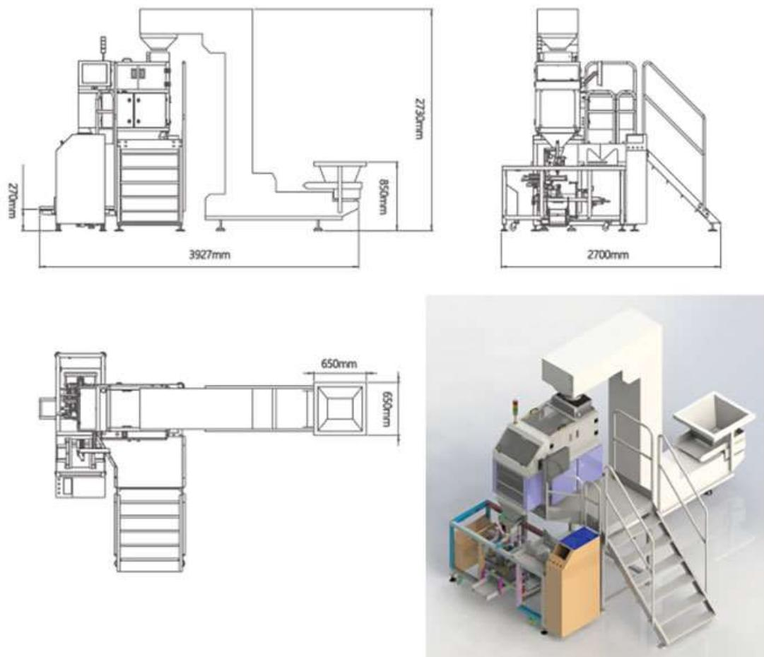
Prilagođeni sistem za podizanje proizvoda do usipnog koša + sistem za brojanje + sistem za štampanje etiketa + sistem za pakovanje + sistem transporta upakovanih proizvoda
