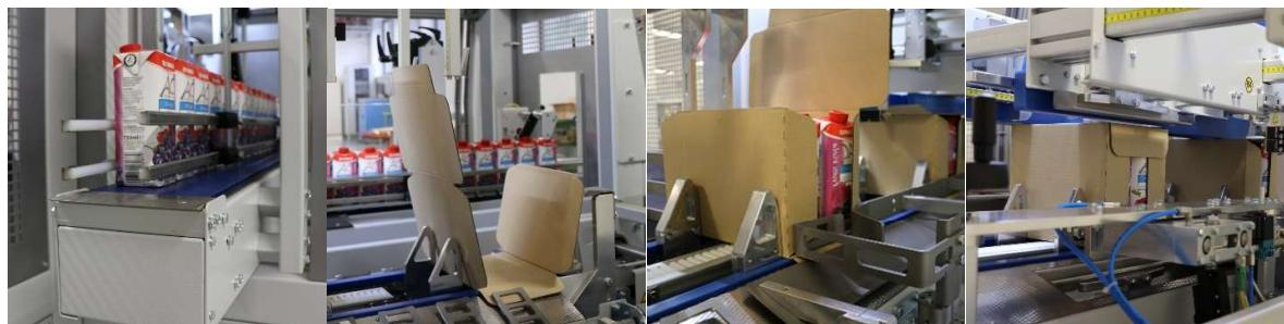
WPS serija automatskih masina za tzv wrap-around case packer je dizajnirana da pakuje veliki broj različitih proizvoda zadovoljavajući najviše standarde i kvalitet.. Kompaktan dizajn masina omogucava snjanje potrebnog prostora za rad i zahvaljujući visoko razvijenim tehnoloskim komponentama moguće je zadovoljiti visoku produktivnost uz redukovanje potrebnog vremena za rad
