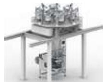
Automatska linija za brojanje i pakovanje sa povišenom platformom za module. Moduli za brojanje su izuzetno fleksibilni i u stanju da ispune mnoge različite tipove proizvoda. Ovaj tip sistema je pogodan za pripremu kompleta i zadovoljava potrebe posebnih proizvodnih zahteva.
