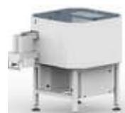
Jednostavan i efikasan, CM-Space je modul za brojanje pokretnom trakom na izlazu iz vibro modula. Koristi se za brojanje gumenih i silikonskim proizvoda. Odstojna pokretna traka pomera proizvode dalje od vibratora i broji ih fotoćelijom na krajnjoj tački dodavanja u korpu.
