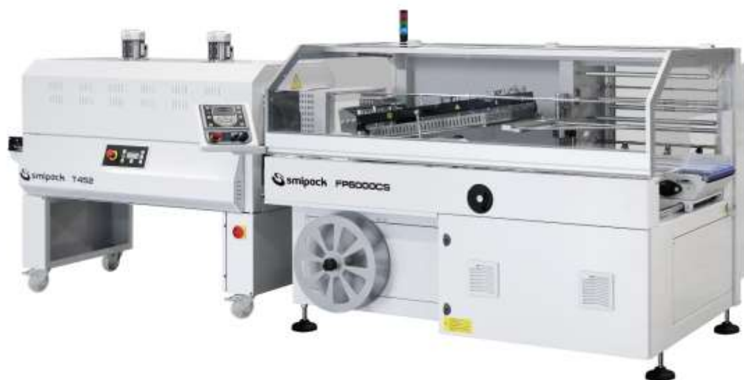
Slika 1. Automatska mašina za termoskupljanje FP6000CS + Tunel T452
