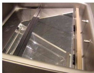
Slika 2. Postavljanje kose ploče unutar komore
