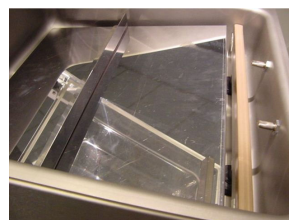
Slika 2. Postavljanje kose ploče unutar komore
